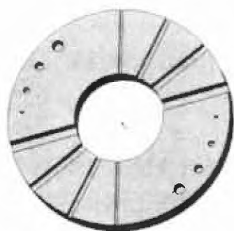
图 42 德国拜耳提出的一种管子-管板角焊缝射线检测像质计
