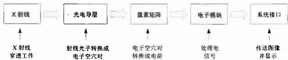
图 2 探测器光电直接转换过程
